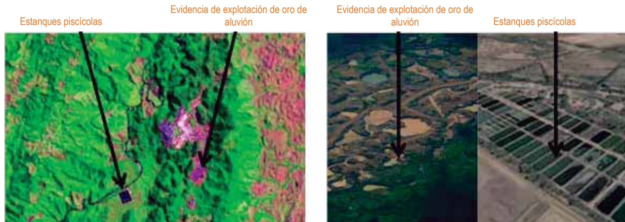
Ilustración 22. Izquierda EVOA y estanques piscícolas (Landsat 8 falso color RGB 652). Derecha Foto Estanques (fuente ICA) y EVOA, sobrevuelo SIMCI.
