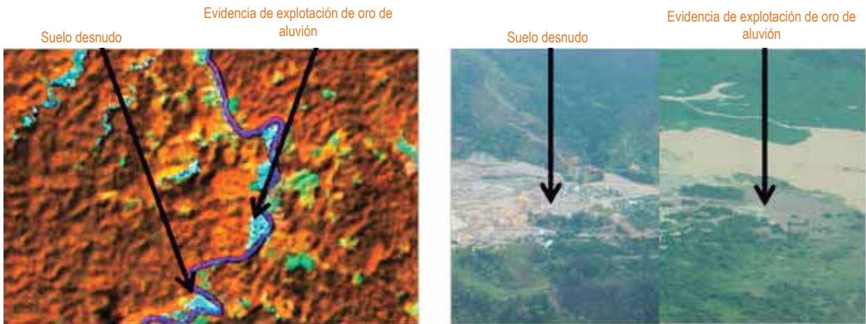
Ilustración 24. Izquierda EVOA y suelo desnudo (Landsat 8, falso color RGB 564). Derecha Foto Suelo desnudo y EVOA, sobrevuelo SIMCI.
