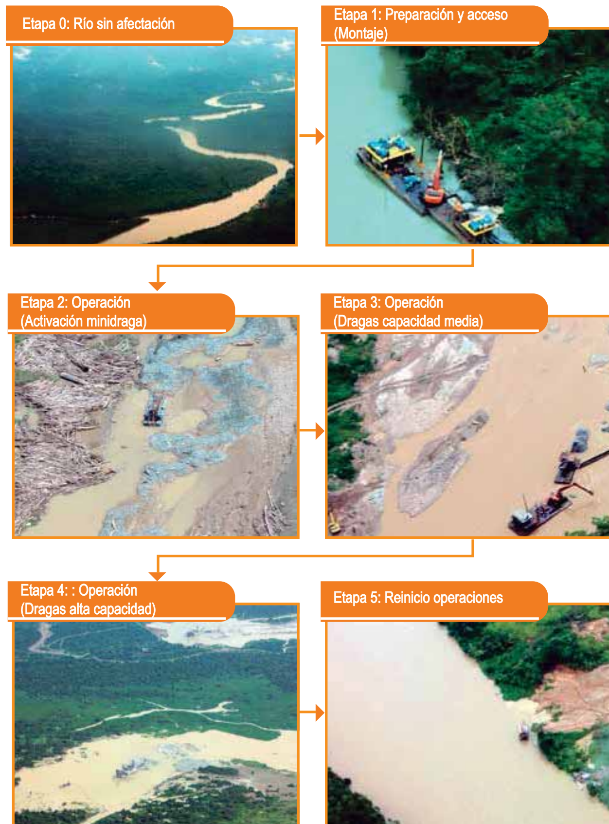
Ilustración 7. Etapas del proceso de explotación de oro de aluvión con uso de maquinaria en agua.
