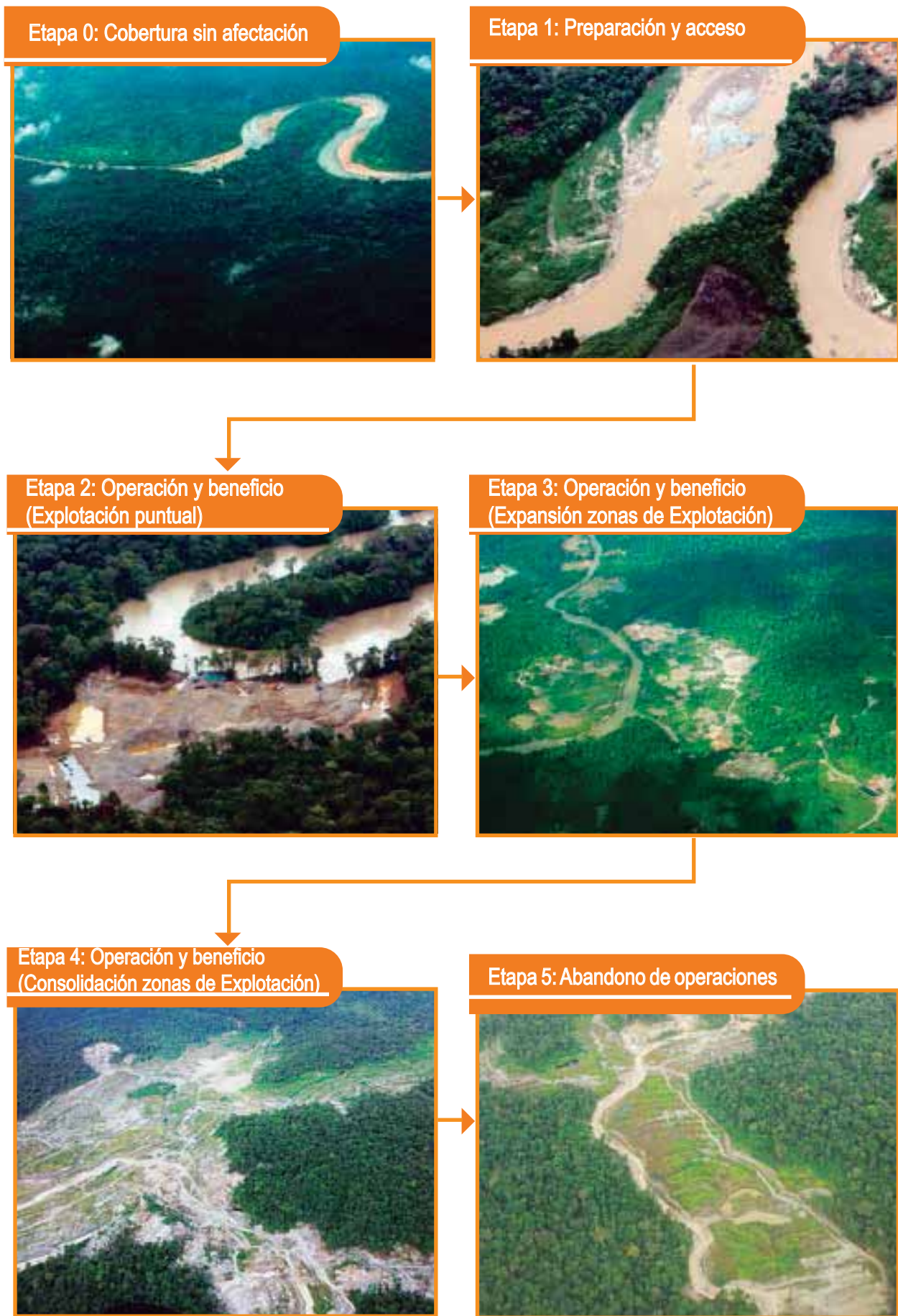
Ilustración 16. Etapas del proceso de explotación de oro de aluvión con uso de maquinaria pesada en tierra.
