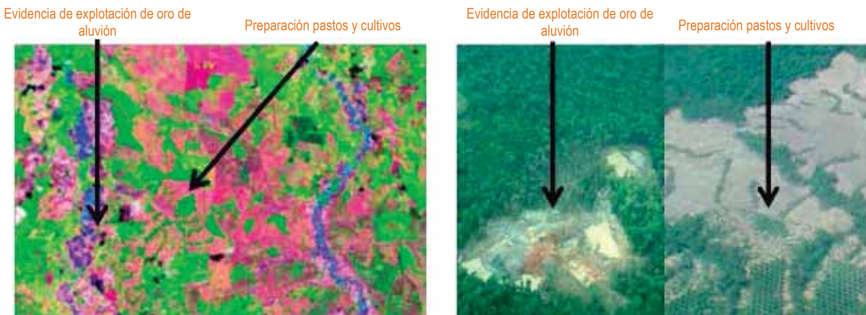
Ilustración 25. Izquierda EVOA y suelo desnudo (Landsat 8, falso color RGB 652). Derecha Foto preparación de terreno y EVOA, sobrevuelo SIMCI.
