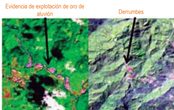
Ilustración 20. Izquierda EVOA y derrumbe, (Landsat 8, falso color RGB 652). Derecha Foto derrumbe y EVOA, sobrevuelo SIMCI.
