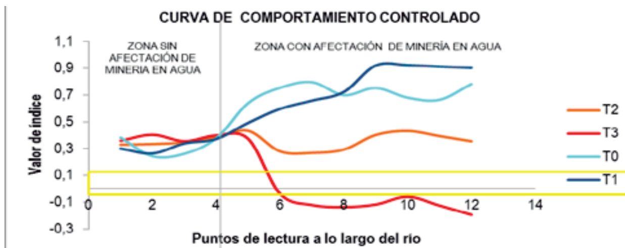
Ilustración 8. Curvas esperadas de afectación, valores cercanos a 1,0 indican menos sedimentos en suspensión, basado en (Hossain, Jia & Chiao; 2016)
