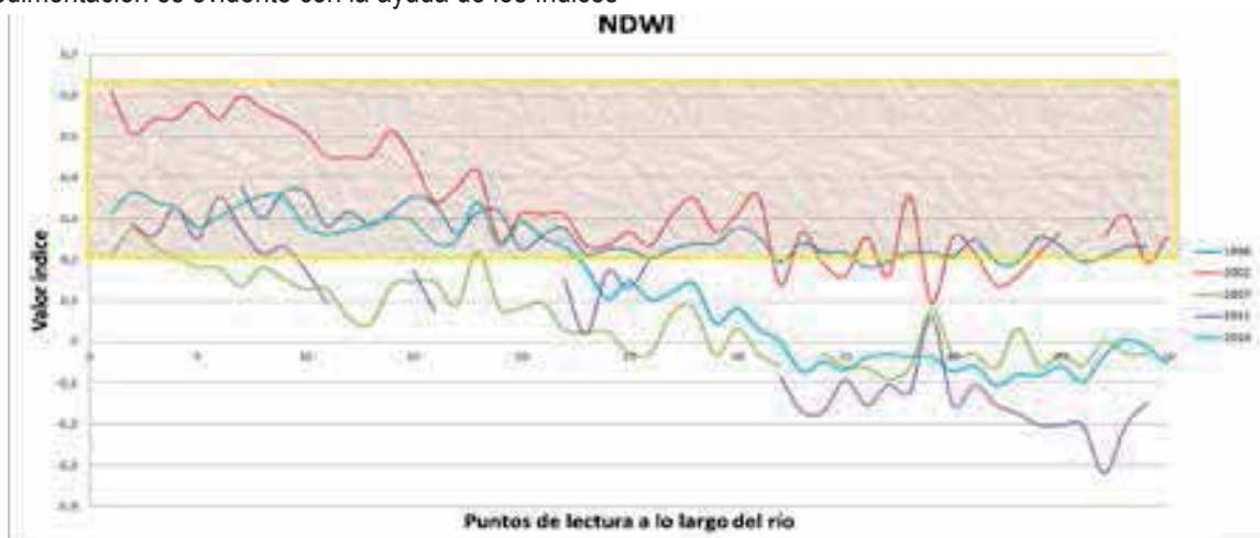
Gráfico 24. Curva de comportamiento espectral de sedimentos en suspensión mediante aplicación de NDWI en zona piloto.
