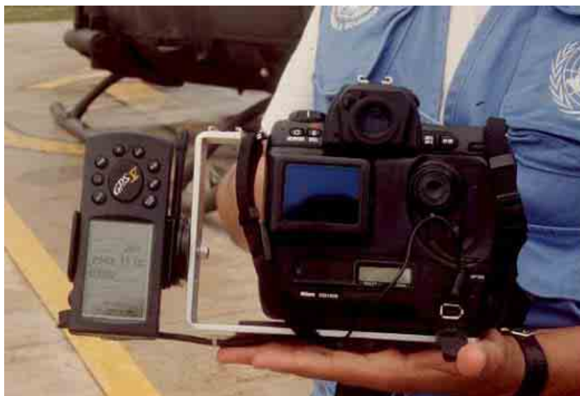
Cámara digital con unidad de GPS
